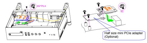
Step 5-1: Installing mini PCIe module and Antenna(s)
